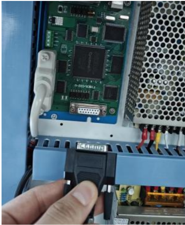
图 3-1 (c) 将原控制卡振镜信号的DB15口拔出。
